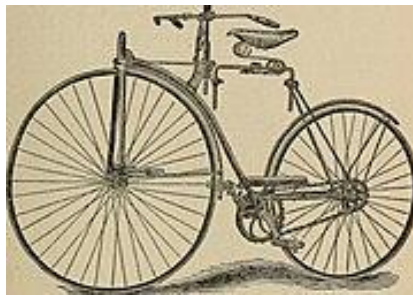
Sicherheitsniederrad Rover I vom Engländer Starley 1885
